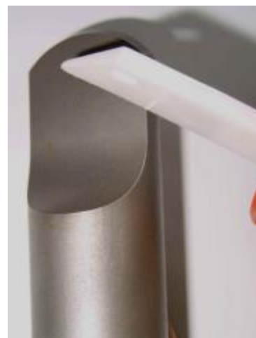
Auch das Brechen der Kanten bei gehärteten Werkzeugen funktioniert einwandfrei
